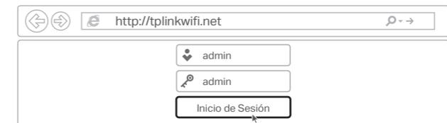
3. Ejecute la Configuración Rápida, seleccione **Router inalámbrico** y siga las instrucciones paso a paso para configurar la conexión a Internet.
